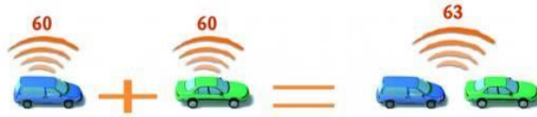
Figure 4 : addition de 2 sources sonores de même intensité (source : www.bruitparif.com )
